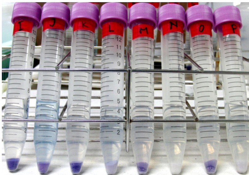
Gambar 4. Hasil fotodegradasi biru metilena dengan nanokomposit zeolit/TiO 2 . (I) nanokomposit zeolit Indonesia/2,5 % TiO 2 ; (J) nanokomposit zeolit Jepang/2,5 % TiO 2 ; (K) nanokomposit zeolit Indonesia/5 % TiO 2 ; (L) nanokomposit zeolit Jepang/5 % TiO 2 ; (M) nanokomposit zeolit Indonesia/10 % TiO 2 ; (N) nanokomposit zeolit Jepang/10 % TiO 2 ; (O) nanokomposit zeolit Indonesia/15 % TiO 2 ; (P) nanokomposit zeolit Jepang/15 % TiO 2
